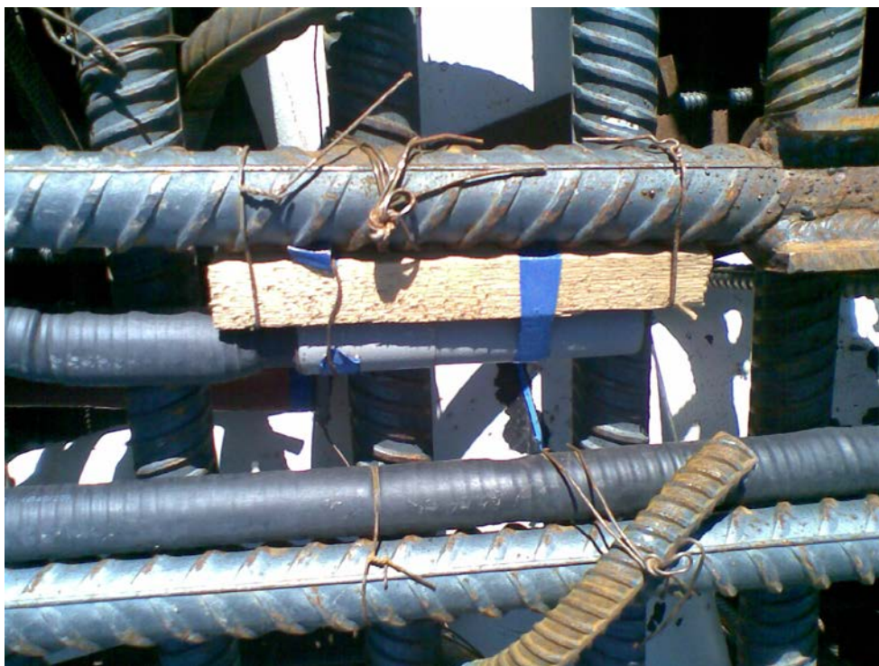
Рисунок 1.15. Датчик измерения температуры тела бетона TermoTC
