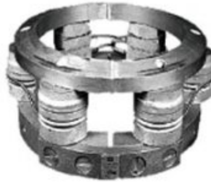
Рисунок 1.16. Тензорезисторный датчик силы НВ 005
