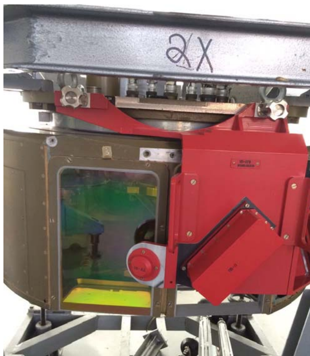
Рисунок 4.3– Призмный блок установленный на ОПС-28
