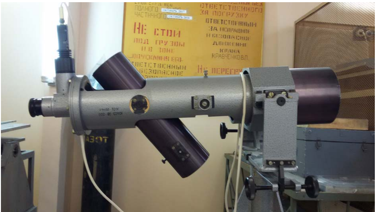
Рисунок 4.1– Автоколлимационная труба с двумя полями зрения
