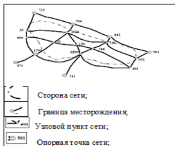
Рисунок 2 - Рекомендуемая схема нивелирных ходов (в первом приближении) для наблюдений за вертикальными смещениями
