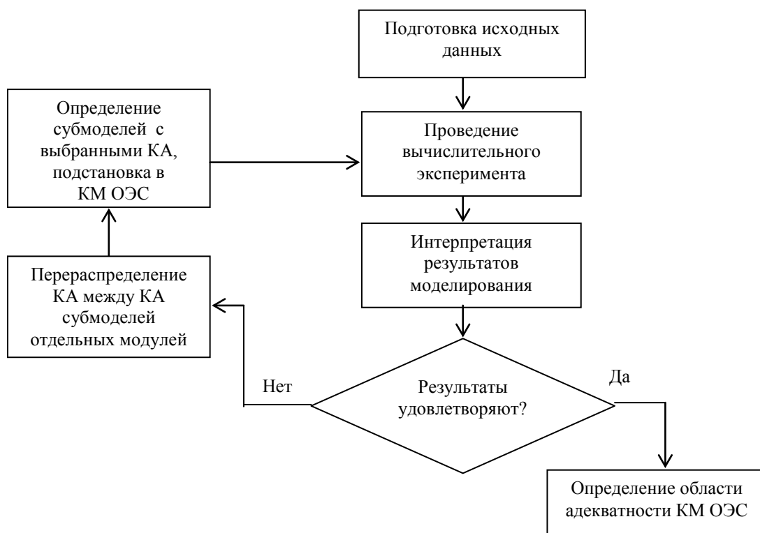
Рис. 10. Схема оптимизации КМ ОЭС из условия адекватности модели
