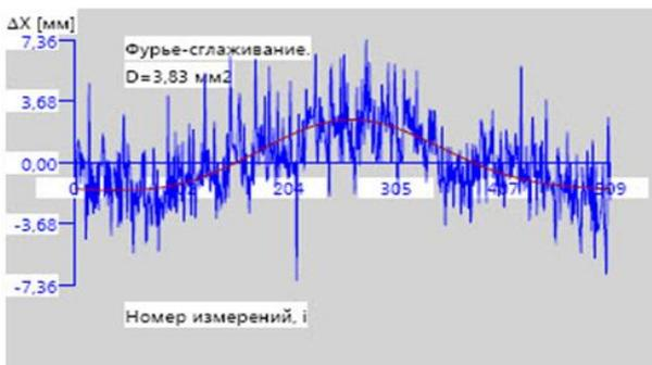
Рисунок 3 – Изменения значений координаты  $x$  и плавная кривая на выходе низкочастотного фильтра (2 гармоники)
