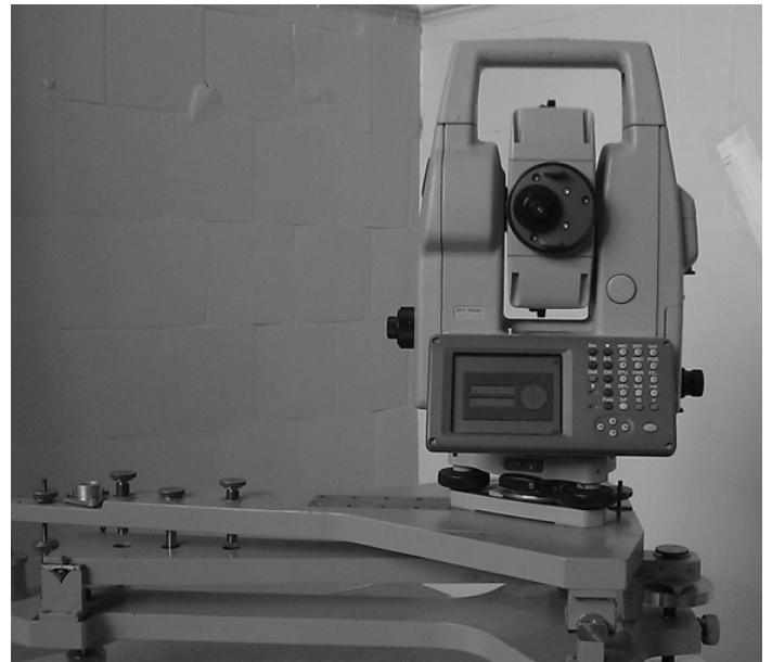
Рис. 12. Topcon GPT-7003i, установленный на экзаменаторе.
