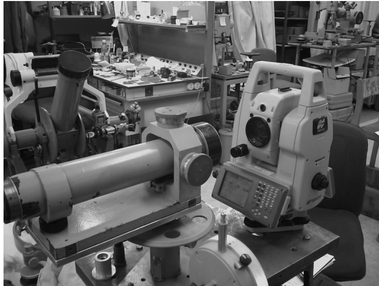
Рис. 8. Тахеометр Topcon GPT-7003i при исследованиях МПИ.
